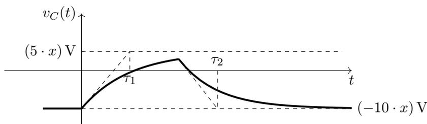
$$v_C(t) = \begin{cases} (-10 \cdot x) \text{ V}, & t < t_0 \\ (5 \cdot x - 15 \cdot x) \cdot e^{-\frac{t}{\tau_1}}, & t_0 < t < t_1 \\ (-10 \cdot x + 13 \cdot x) \cdot e^{-\frac{t-t_1}{\tau_2}}, & t > t_1 \end{cases}$$
