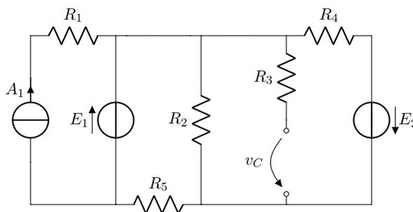
Il generatore di corrente  $E_1$  disaccoppia la rete. La parte di destra si risolve con Millman:
